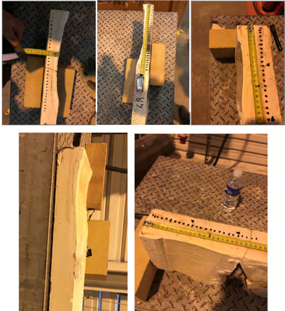
热修后复原的一些耐火砖图片
